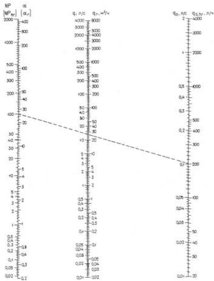
Черт. 4. Номограмма для определения секундных и часовых расходов воды в зависимости от  $NP$  ( $NP_{hr}$ ) при различных значениях  $q_0, \text{ л/с}$ , и  $q_{0, \text{ hr}}, \text{ л/ч}$
