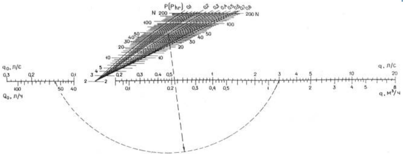
Черт. 3. Номограмма для определения секундных и часовых расходов воды  $q$  при  $q_0 \in 0,3$  л/с,  $N \in 200$  и  $P > 0,1$
